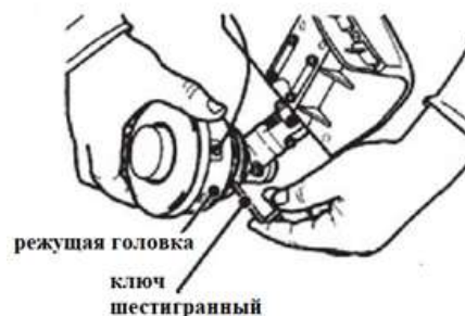
Рис. 5 Установка косильной головки.
